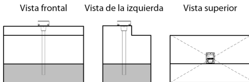
Figure 1. Selección del lugar de instalación del sensor Omnicomm LLS 6 AI
